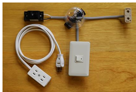
電灯配線作業とテーブルタップ製作
