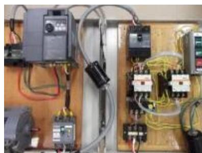
■実際のモータを使用して、基本である制御回路を学び、さらにボタンを押すだけで回転方向を変える応用回路を作ります。
