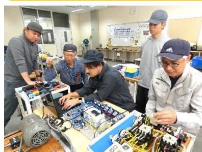
■実際のモータを使用し、工場で用いられる制御回路を製作します。
